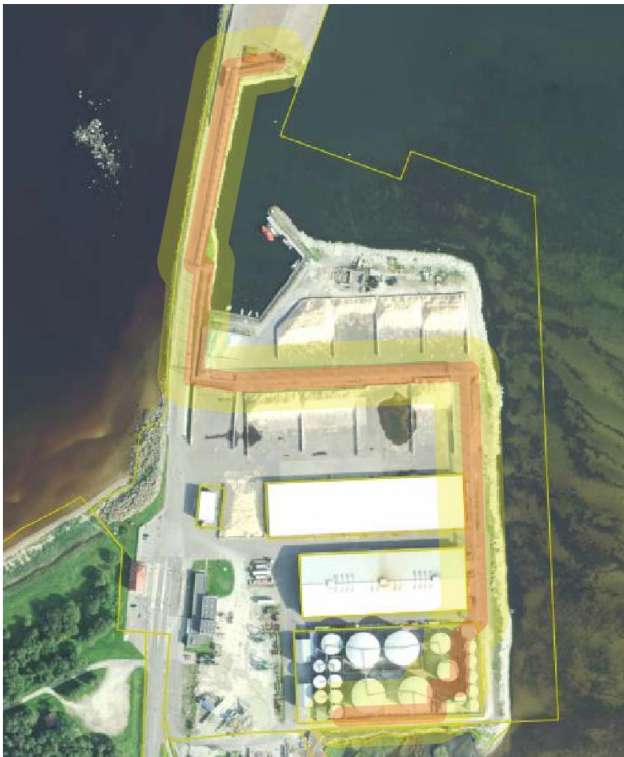
Skeem 6. Produktorust lekkinud põlevvedeliku ohualad ehitistele: 10 m ja inimelule: 30 m.
